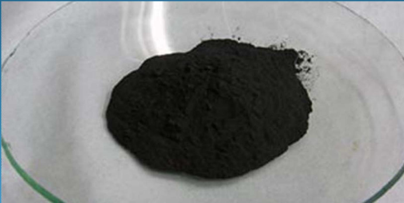
Producto final: El material obtenido es enviado a la fábrica de elementos combustibles donde es prensado, obteniéndose pastillas que al ser sinterizadas adquieren la densidad necesaria para ser utilizadas como combustible nuclear. Fuente: DIOXITEK S.A., <http://www.dioxitek.com.ar>
